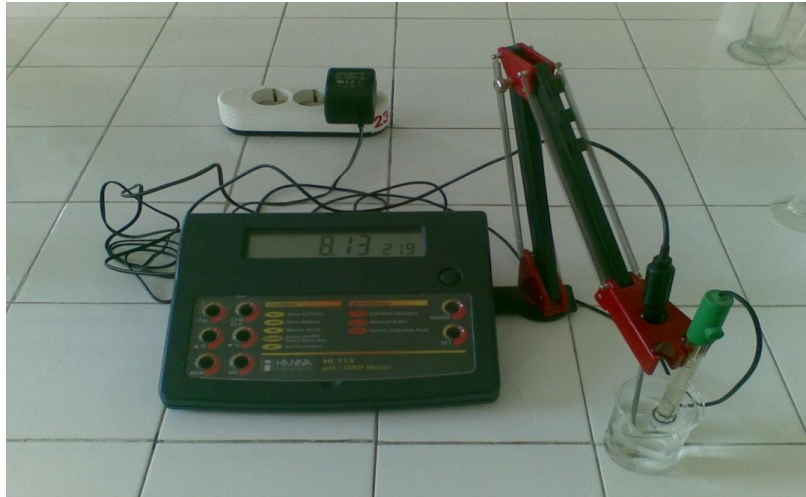
Fig. 1. Digital pH meter Hanna HI 113
